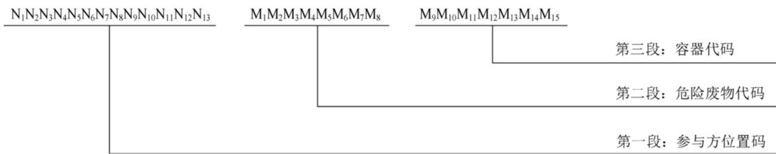
图 1 危险废物储运单元代码结构
